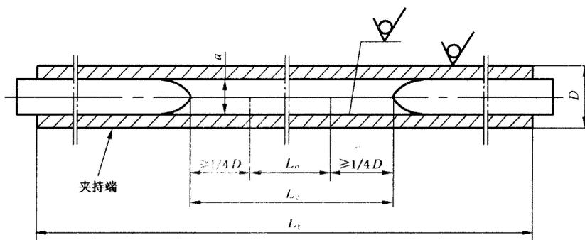
图 D1 管段试样的塞头位置
