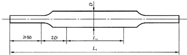
图 D2 管段试样的两夹持头部压扁
