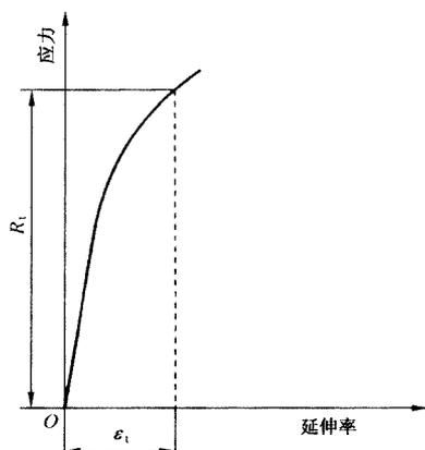
图4 规定总延伸强度( $R_t$ )4.9.5 规定残余延伸强度( $R_r$ ) permanent set strength
