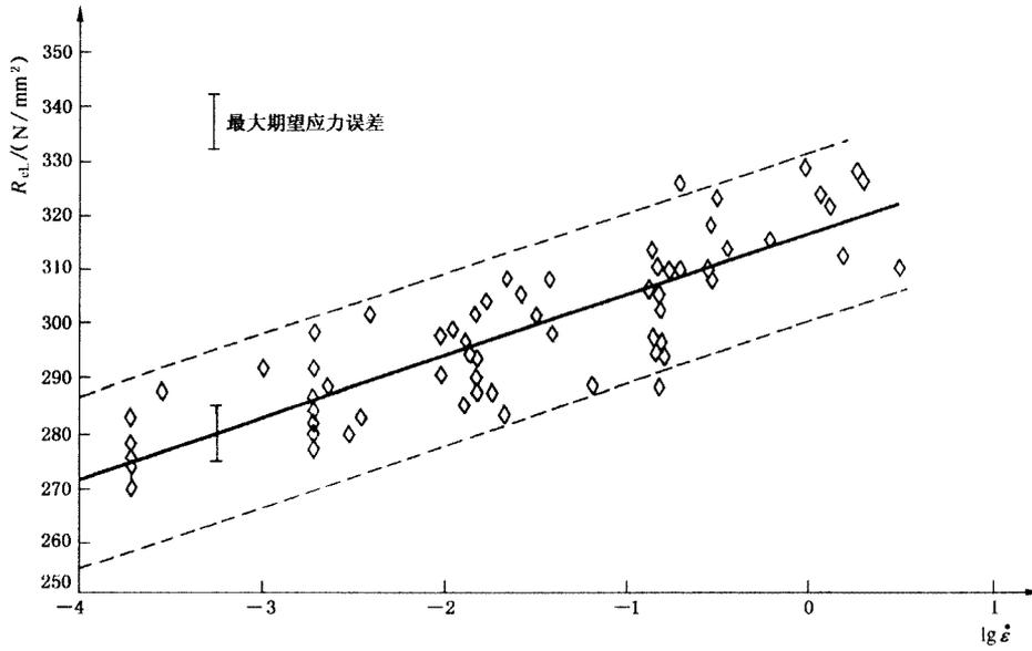
注： $\dot{\epsilon}$  = 塑性应变速率, 单位为  $(\text{mm}/\text{mm}) \cdot \text{min}^{-1}$ 。
