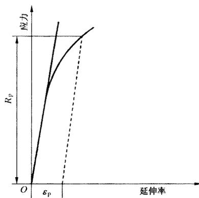
图3 规定非比例延伸强度( $R_p$ )4.9.4 规定总延伸强度( $R_t$ ) proof strength, total extension
