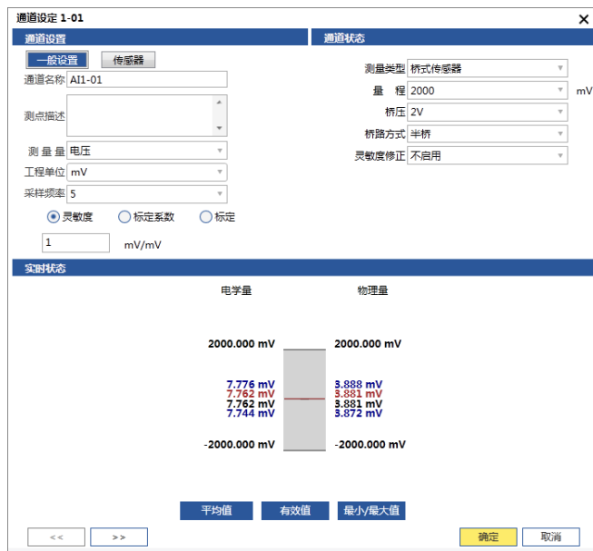
图 6.13 电压测量通道
